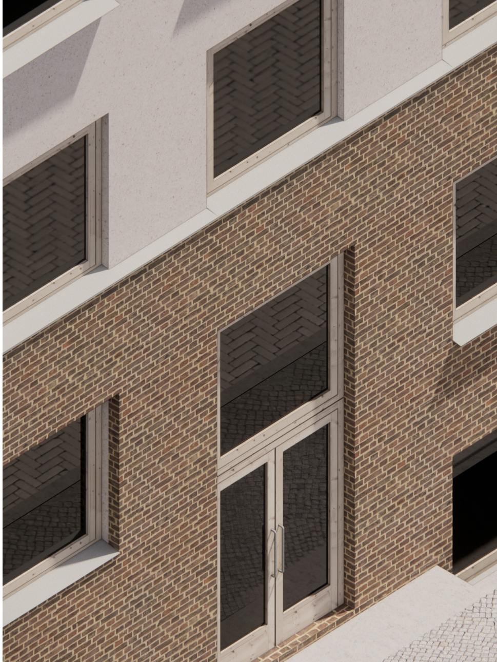
Isometri, visualisering Udsnit af pudset og teglbeklædt etagebyggeri i blokmur
